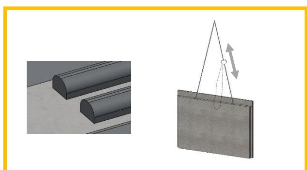
3. Ajuster le niveau horizontal sur le système d'élingage
