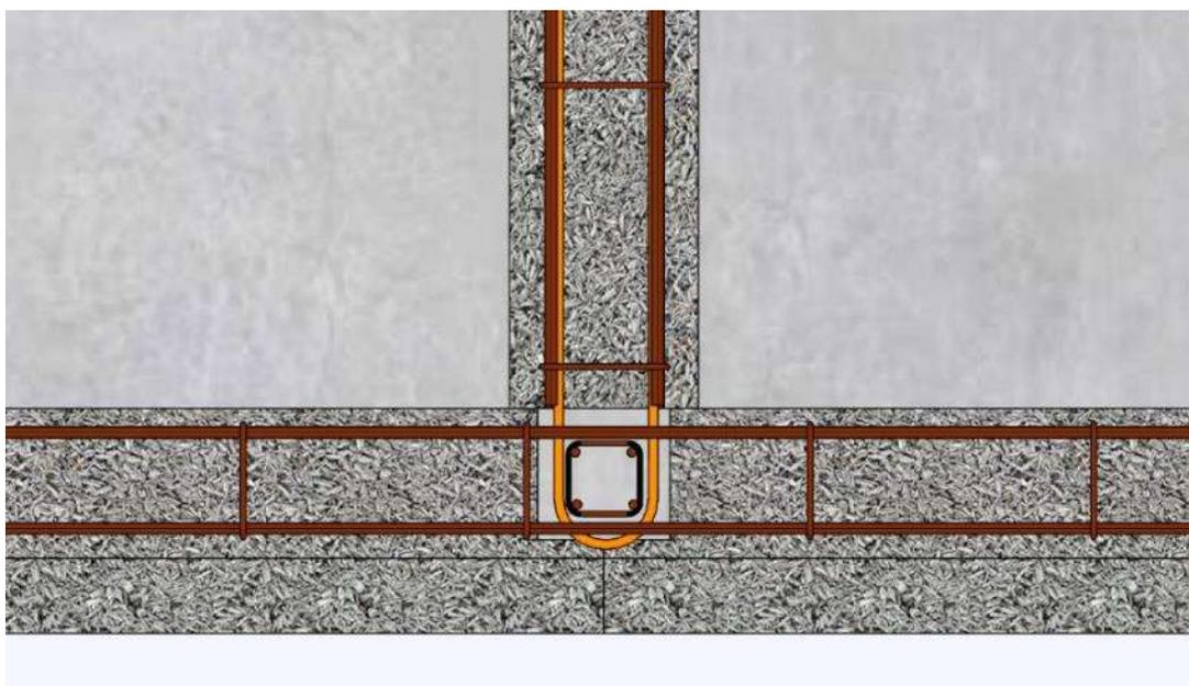
Figure A15 : Continuité des armatures de chaînages horizontaux avec boucles U – Liaison refend /
