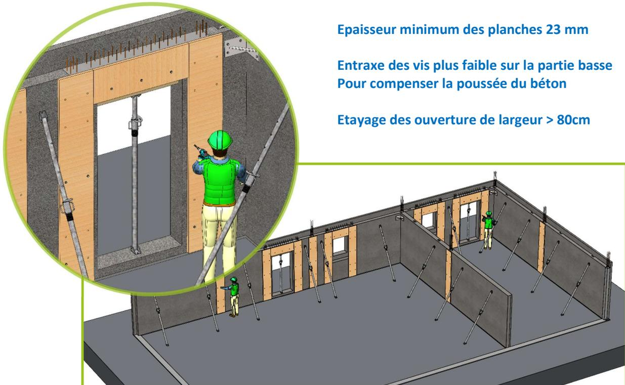
Les réservations sont fermées par des planches de coffrage, préalablement huilées sur la face intérieure. Les planches sont directement fixées par vissage dans le béton de bois à raison de minimum 4 vis M10\*120 par côté sur la hauteur d'un panneau de 3 m.
