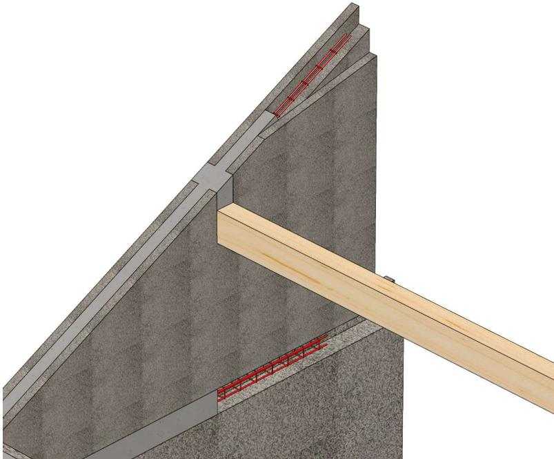
Les pannes doivent être fixées au mur pignon : tirefonds ou fixations métalliques de type équerres ou consoles.
